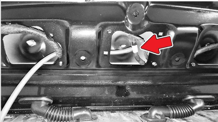
**9** Для регулировки форсунки используйте кнопку - гвоздь (в комплекте), согнув её плоскогубцами, как это показано на рисунке.
