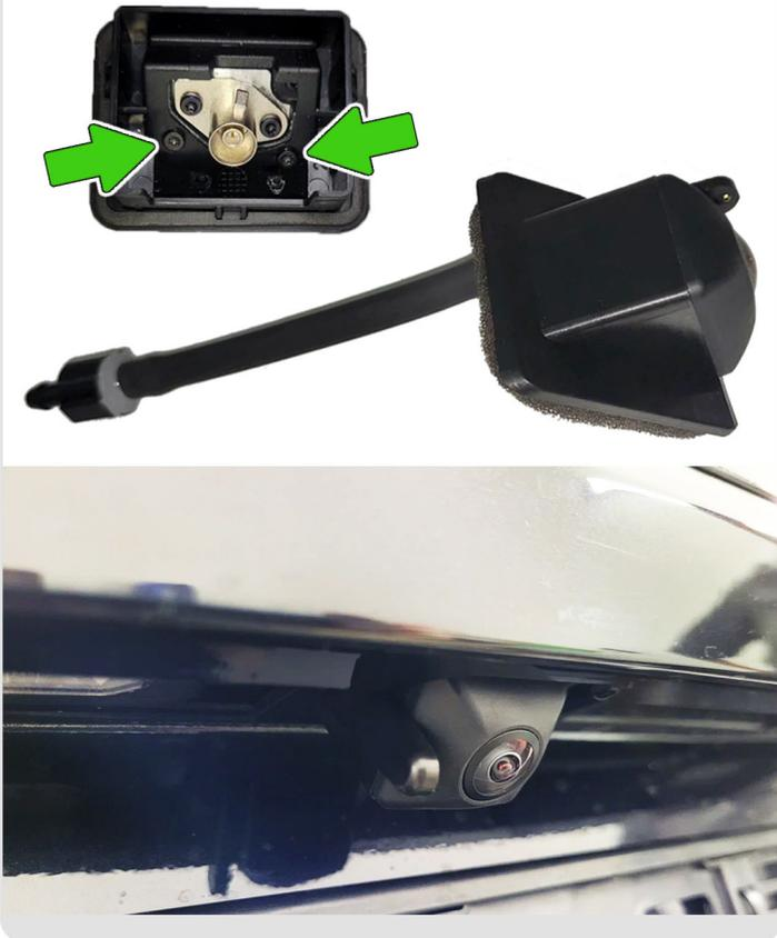
**8** Включите омыватель заднего стекла, убедитесь в отсутствии течей. Сборка авто осуществляется в обратной последовательности (при сборке убедитесь, что устанавливаемые накладки не пережимают шланг подачи жидкости к омывателю камеры).
