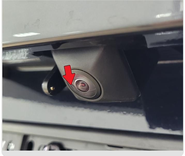
**7** Разрежьте штатный шланг форсунки омывателя заднего стекла и установите **тройник** из комплекта в место разреза. Протяните шланг к камере, закрепите его стяжками на штатной проводке.
