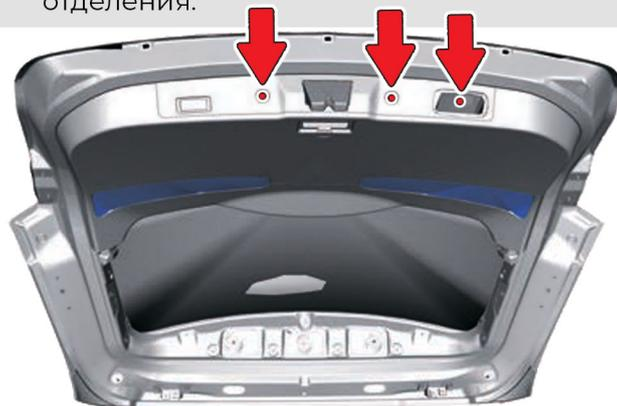
**4** Открутите **пять саморезов** крепления нижней обивки двери багажного отделения.
