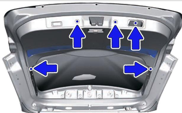
**5** Оттягивая **камеру** свободите фиксаторы изнутри и снимите камеру заднего вида.
